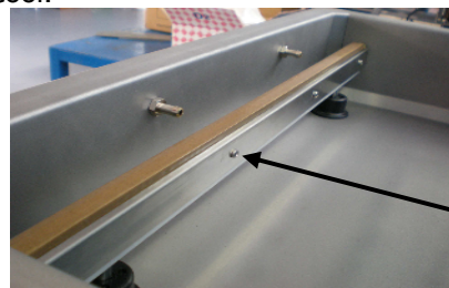
Figura 8.1. Barra saldante presente all'interno della vasca.
