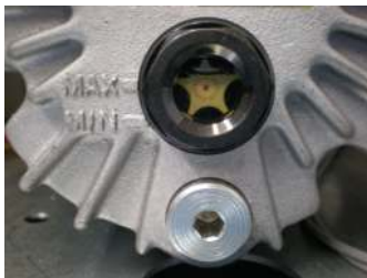
Figura 5.1. Indicatori di livello olio della pompa.
