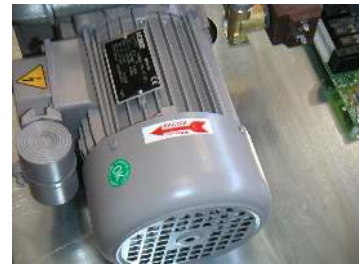
Figura 5.2. Freccia indicante il senso di rotazione.
