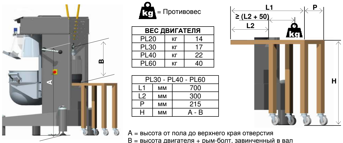
Рисунок 21– Инструмент для упрощения процедуры установки/демонтажа двигателя
